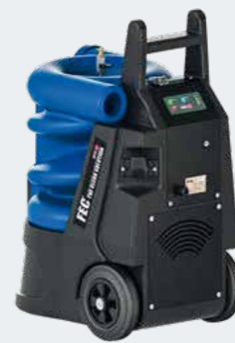
BINZEL 073715 • 230V / 1~, 1100 W • 230 m³/h max • 190 mbar max • 25 kg, 590 x 425 x 825 mm • 76 db • Filter auto cleaning system - Système de nettoyage automatique du filtre - Automatische Filterabreinigung Filtre Classe M, EN 60335-2-69 included : 5 m, Ø50
