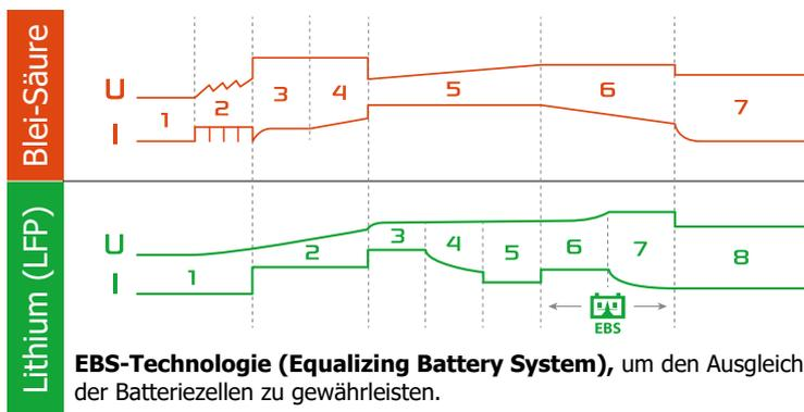
Spezifischer Ladezyklus in **7 Stufen, ohne Überwachung.**
