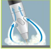
Brenner, der auf der Grundlage von MIG/MAG-Standardbrennern für die Absaugung von Dämpfen an der Quelle entwickelt wurde. In Verbindung mit einem BINZEL Filterstaubsauger oder angeschlossen an eine zentrale Absauganlage schützt der Saugbrenner die unmittelbare Arbeitsumgebung des Schweißers.
