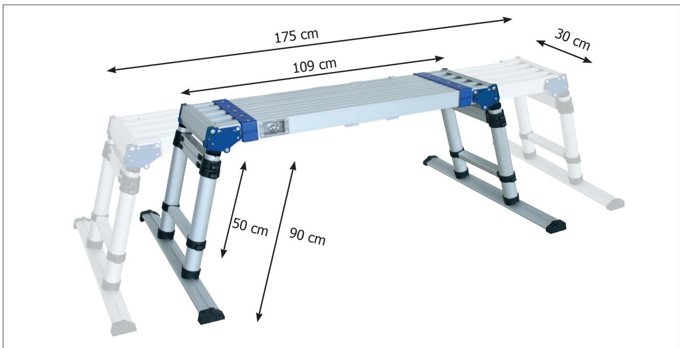
Die Höhe (50 bis 90 cm) und die Länge (100 bis 175 cm) der Arbeitsbühne lassen sich zur einfachen Anpassung an vielfältige Arbeiten einstellen. Die Breite der Arbeitsbühne beträgt 30 cm.
