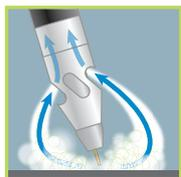
Torche étudiée pour l'aspiration et l'évacuation des fumées à la source sur la base des torches standard MIG/MAG. Associée à un aspirateur filtrant BINZEL ou branchée sur un circuit d'aspiration centralisé, la torche aspirante permet de protéger l'environnement immédiat du soudeur.
