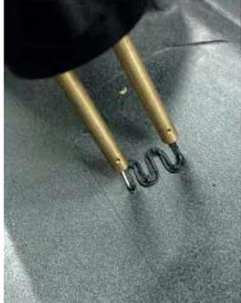
**Parcourue par un courant, l'agrafe chauffe et peut ainsi pénétrer dans la matière plastique pour réparer tous types de fissures.**
