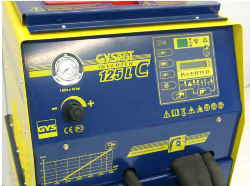
Bedienfeld Und Weldtester der Gys Schweißmaschine
