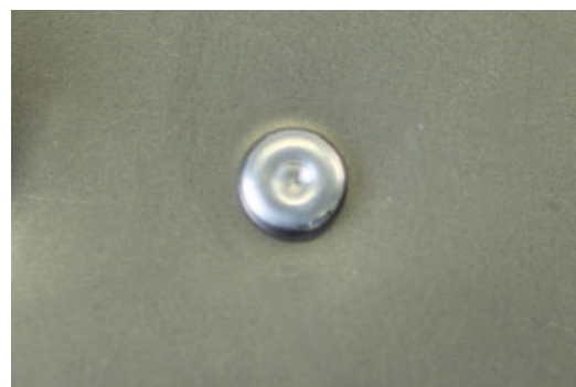
РЕЗУЛЬТАТ УСТАНОВКИ ЗАКЛЕПКИ ТЕКУЩЕЙ ФОРМЫ FLOW-FORM
