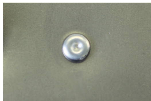
RISULTATO DELLA POSA DI UN RIVETTO FLOW-FORM
