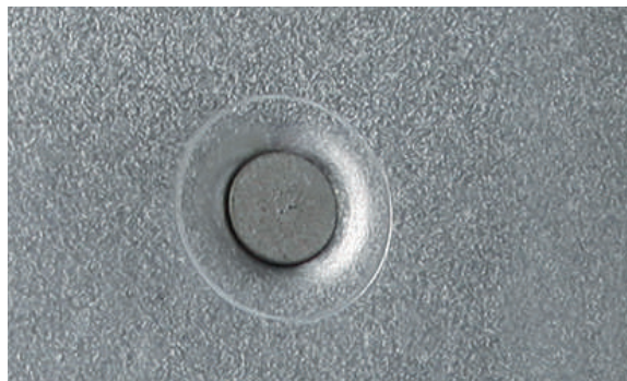
RÉSULTAT DE POSE D'UN RIVET AUTO-PERÇANT
