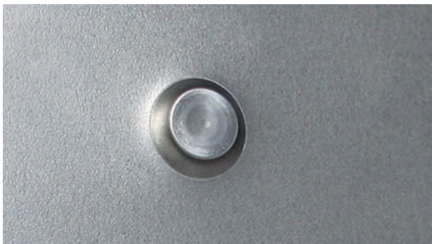
RESULTADO AL PONER UN REMACHE AUTOPERFORANTE
