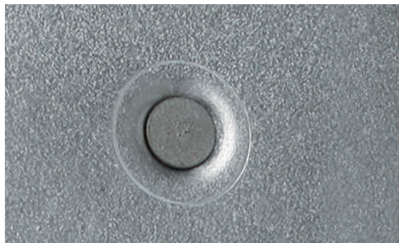
РЕЗУЛЬТАТ УСТАНОВКИ САМОПРОНИКАЮЩЕЙ ЗАКЛЕПКИ
