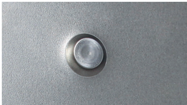
РЕЗУЛЬТАТ УСТАНОВКИ САМОПРОНИКАЮЩЕЙ ЗАКЛЕПКИ
