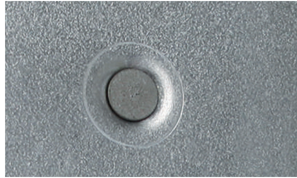
ABBILDUNG STANZNIETVERBINDUNG VORDER- U. RÜCKSEITE
