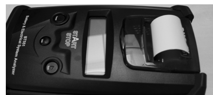
C. Colocar una corta longitud de papel del compartimiento y presionar sobre la tapa transparente para cerrar.
