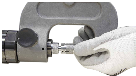
アーム備品のエクステンションをネジ付けしてください。
