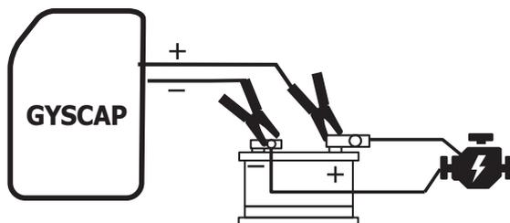
Substituir a montagem : Alicate e clipe vermelho (+) no poste da bateria (+).
