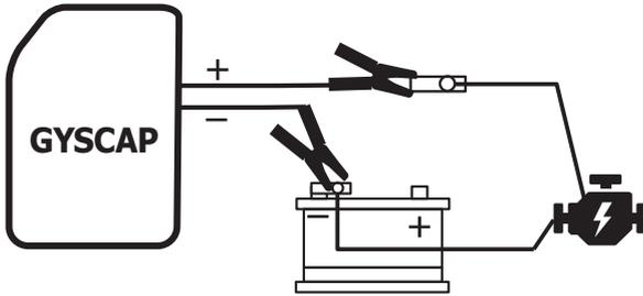
Desconecte o terminal (+) da bateria e conecte o grampo vermelho (+) do GYSCAP a ela.
