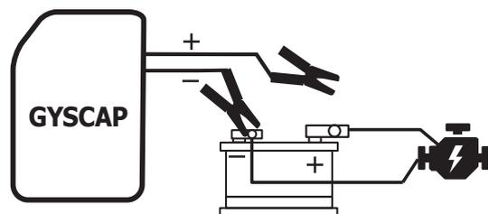
Remova o Alicate vermelho (+) do terminal conectado à bateria.
