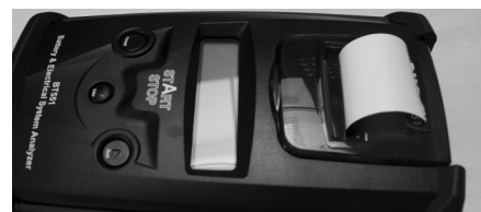
C. Srotolare una piccola lunghezza di carta in modo da farla fuoriuscire e premere sul coperchio trasparente per chiuderlo.
