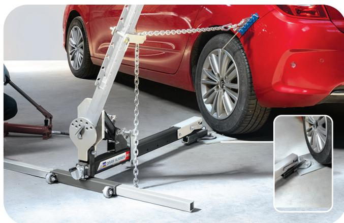
Für Räder ist ein Unterlegteil vorhanden, so dass der Zugvorgang auch an hinteren Fahrzeugpartien stattfinden kann.
