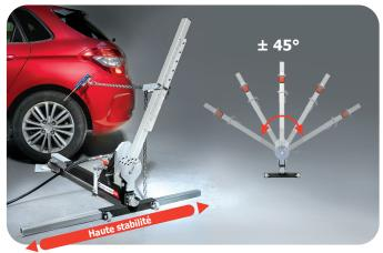
La barra de tracción vertical puede inclinarse hacia la izquierda y la derecha, esto permite ajustar **la dirección de tracción a** +/- 45°.
