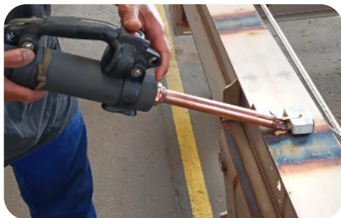
Redressage sur châssis Inox/Acier
