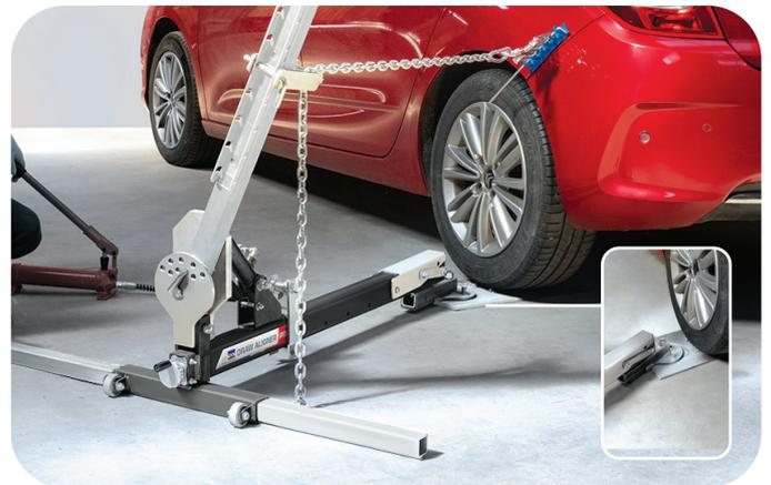
Lo spessore sotto ruota permette la trazione delle parti posteriori del veicolo.
