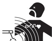
Prąd elektryczny przechodzący przez jakikolwiek przewodnik wytworza zlokalizowane pola elektryczne i magnetyczne (EMF). Prąd spawania wytworza pole elektromagnetyczne wokół obwodu spawalniczego i sprzętu do spawania.
