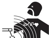
La corriente eléctrica causa campos electromagnéticos (EMF) localizados al pasar por cualquier conductor. La corriente de soldadura produce un campo electromagnético alrededor del circuito de soldadura y del material de soldadura.
