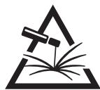
Proteggere completamente la zona di saldatura, i materiali infiammabili devono essere allontanati di almeno 11 metri.
