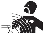
La corrente elettrica che attraversa un qualsiasi conduttore produce dei campi elettrici e magnetici (EMF) localizzati. La corrente di saldatura produce un campo elettromagnetico attorno al circuito di saldatura e al dispositivo di saldatura.
