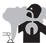
Kouř vznikající při svařování obsahuje škodlivé plyny a výpary. Zajistit dostatek čerstvého vzduchu, může být nutné používat způsobilý dýchací přístroj. Pokud nedostačuje větrání, použijte ochrannou dýchací kuklu s přívodem vzduchu.
