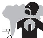
Beim Schweißen entstehen Rauchgase bzw. toxische Dämpfe. Sorgen Sie daher immer für ausreichende Frischluftzufuhr, technische Belüftung oder ein zugelassenes Atemgerät.
