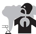
Dampen, gassen en stof uitgestoten tijdens het lassen zijn gevaarlijk voor de gezondheid. Zorg voor voldoende ventilatie, soms is toevoer van verse lucht tijdens het lassen noodzakelijk. Een lashelm met verse luchtaanvoer kan een oplossing zijn als er onvoldoende ventilatie is.
