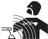
Elektrische stroom die door een geleider gaat veroorzaakt elektrische en magnetische velden (EMF). De lasstroom wekt een elektromagnetisch veld op rondom de laszone en het lasmateriaal.
