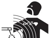
Průchod elektrického proudu v některých vodivých částech způsobuje vznik lokalizovaných elektromagnetických polí (EMF). Svařovací proud způsobuje elektromagnetickou poli v okolí svařovacího obvodu.
