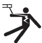
Svařovací agregát smí být připojen pouze k uzemněné elektrické napájecí síti. Jako jisticí prvky používejte pouze doporučený typ pojistek.
