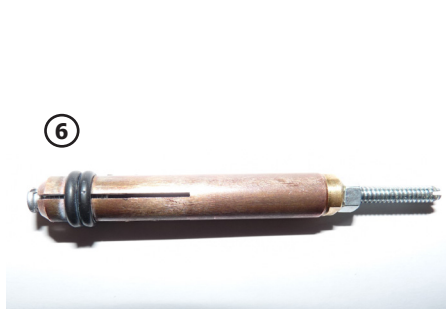
Puntale in rame con 4 fessure per saldare perni in alluminio M4 (diametro Ø 4 mm)
