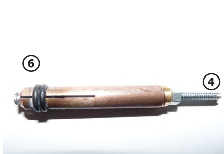
Embout en cuivre à 4 fentes pour souder les goujons M4 (diamètre Ø 4 mm)
