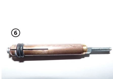
Koperen punt met 4 groeven voor het lassen van M4 nagels (diameter Ø 4 mm)
