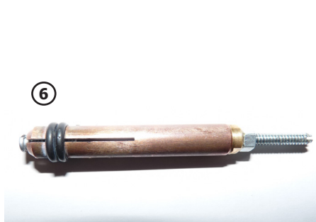
Медный наконечник с 4 прорезами для приваривания шпилек M4 (диаметр Ø 4 мм)
