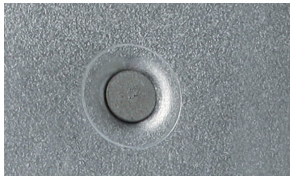
RÉSULTAT DE POSE D'UN RIVET AUTO-PERÇANT
