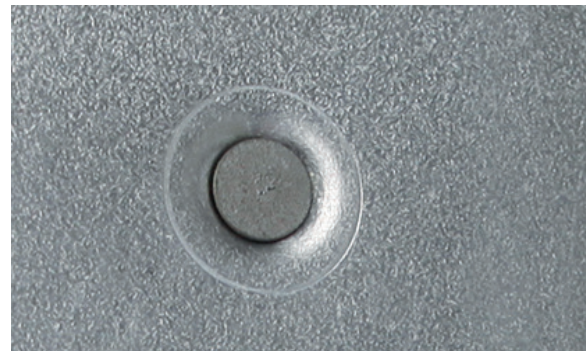
RESULTAAT VAN HET AANBRENGEN VAN SELF-PIERCING PONSNAGELS
