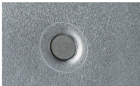
РЕЗУЛЬТАТ УСТАНОВКИ САМОПРОНИКАЮЩЕЙ ЗАКЛЕПКИ
