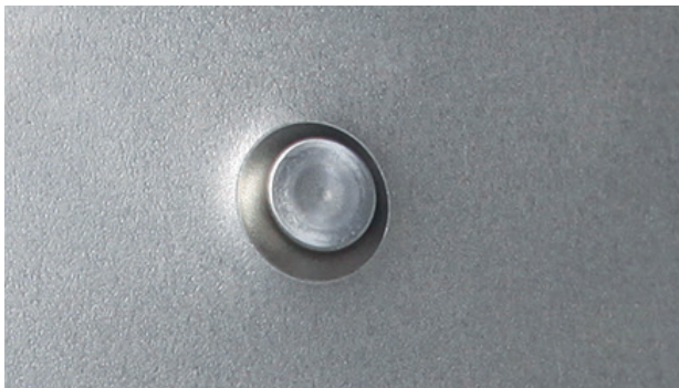
RESULTAAT VAN HET AANBRENGEN VAN SELF-PIERCING PONSNAGELS
