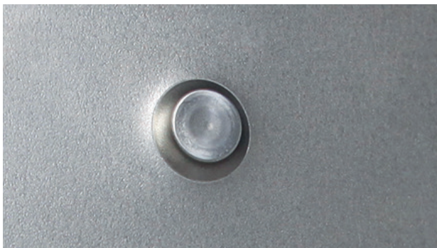
RÉSULTAT DE POSE D'UN RIVET AUTO-PERÇANT
