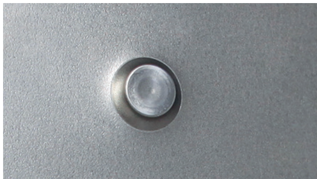
RESULTADO DE LA COLOCACIÓN DE UN REMACHE AUTOPERFORANTE
