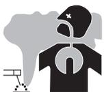
Os fumos, gases e poeira emitidos pelo corte são perigosos para a saúde. Ventilação suficiente deve ser fornecida, a entrada forçada de ar é às vezes necessária. Uma máscara de ar fresco pode ser uma solução em caso de ventilação insuficiente.
