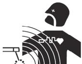
Elektrische stroom die door een geleider gaat veroorzaakt elektrische en magnetische velden (EMF). De lasstroom wekt een elektromagnetisch veld op rondom de laszone en het lasmateriaal.
