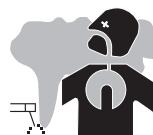
Les fumées, gaz et poussières émis par le soudage sont dangereux pour la santé. Il faut prévoir une ventilation suffisante, un apport d'air est parfois nécessaire. Un masque à air frais peut être une solution en cas d'aération insuffisante.
