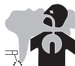
El humo, el gas y el polvo que se emite durante la soldadura son peligrosos para la salud. Hay que prever una ventilación suficiente y en ocasiones puede ser necesario un aporte de aire. Una máscara de aire puede ser una solución en caso de aireación insuficiente.
