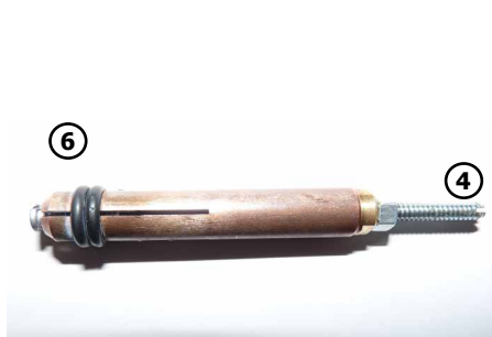
Capac din cupru cu 4 fante pentru lipirea știfturilor M4 (diametru Ø 4 mm)
